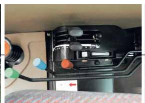
▼ El sistema auxiliar de válvula remota ofrece hasta tres válvulas traseras.
