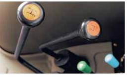
Los cambios de dirección son realizados sin esfuerzo con el uso del control "shuttle", instalado en el lado izquierdo del operador.
