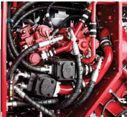
Bomba Parker de tres etapas: mayor caudal de aceite para los motores del picador.
