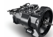
Caja de cambios manual para el motor GH5E de 5 litros
