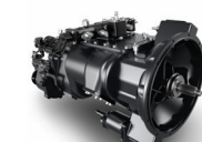
Caja de cambios manual para el motor GH8E de 8 litros
